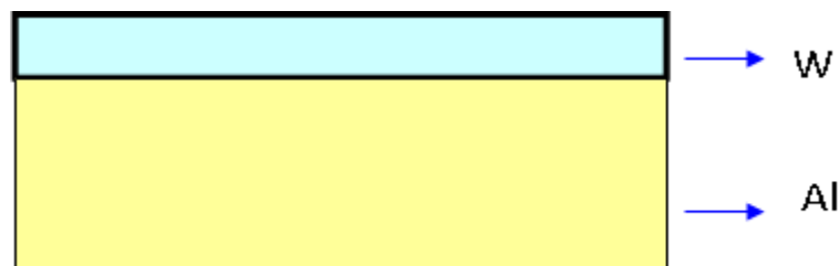
Сурет 3.2 - Вольфрам нысанасын магнетрондық тозаңдату әдісі арқылы вольфрам қабатымен жабындалған үлгінің түрі
