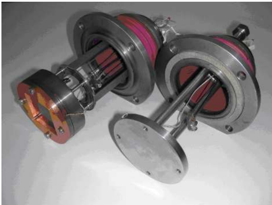
Сурет 2.8 – (Солжағындағы)мишен ұстағыш, электрқыздырғышымен
