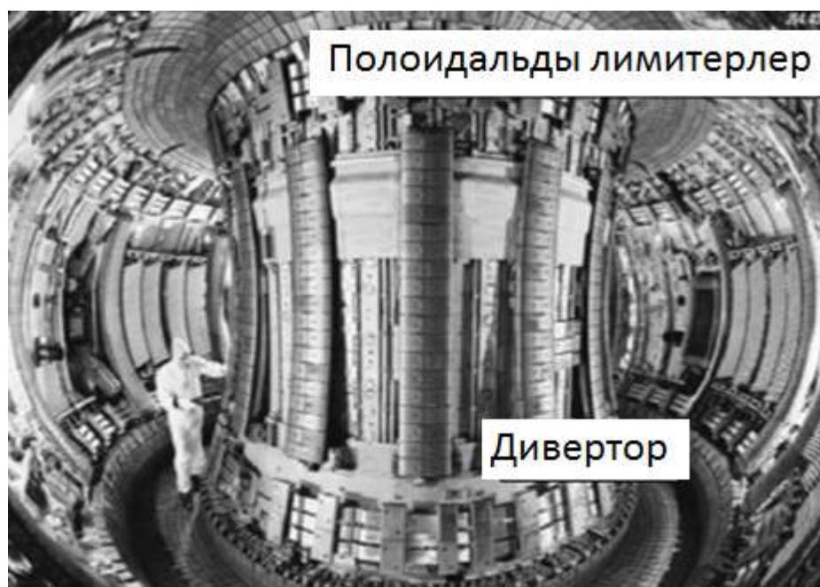
Сурет 1.4 - JET токамагындағы плазмалық элементтеріне айналу конфигурациясы
